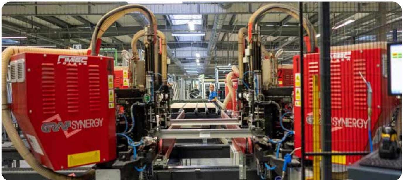
La nostra produzione è dotata di macchine GRAF Synergy all'avanguardia per le saldature invisibili. Il robot SL 4 FF EVO è responsabile della giunzione rapida e stabile dei profili. La saldatura consente di unire gli angoli in modo assolutamente perfetto
