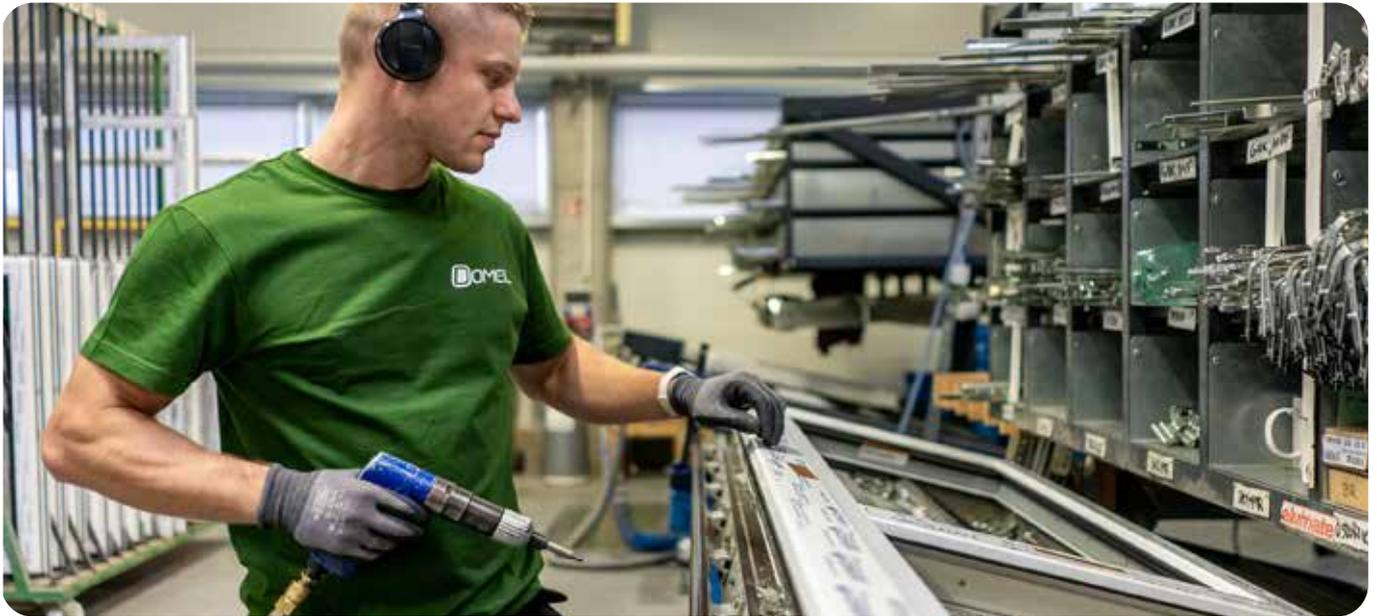
Con qualsiasi altra tecnologia di saldatura del PVC, durante il processo di produzione si creano saldature sgradevoli che devono essere rimosse. Di conseguenza, le parti colorate devono essere riverniciate e i profili devono essere puliti accuratamente a mano.
