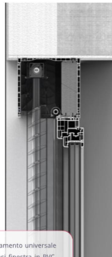
**Frangisole RB-BONN** hanno un profilo di adattamento universale che consente una facile installazione su qualsiasi finestra in PVC, alluminio o legno. Le dimensioni dell'apertura della finestra devono essere aumentate dell'altezza del cassonetto selezionato, per cui l'installazione deve essere presa in considerazione in fase di progettazione o di adattamento dell'edificio.
